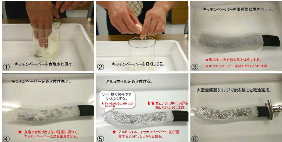
図3 備長炭電池の作り方
